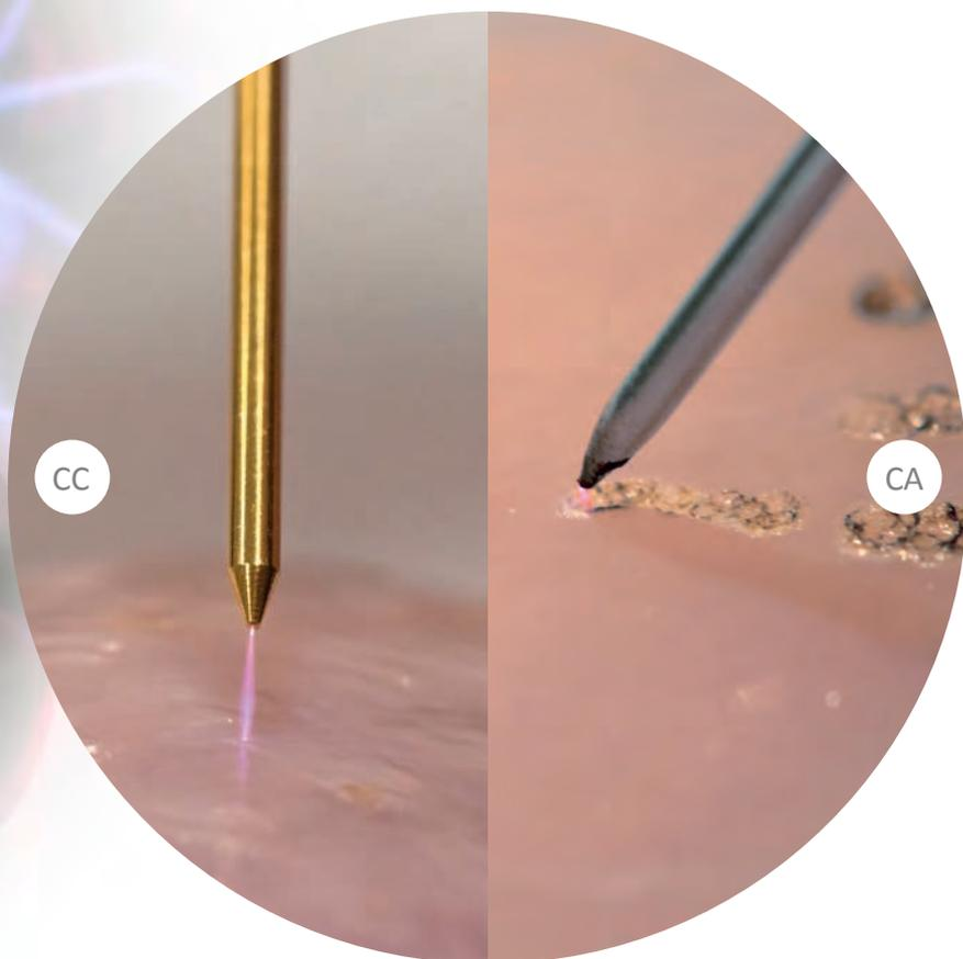
Diferencia en el tamaño de la chispa con corriente continua y corriente alterna.
